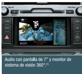
Audio con pantalla de 7" y monitor de sistema de visión 360°.<sup>(1)</sup>
