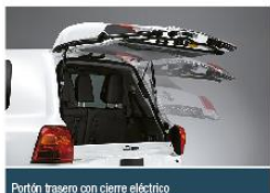
Portón trasero con cierre eléctrico
