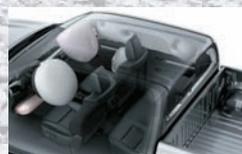
Airbags frontales (conductor y acompañante), de rodilla (conductor), laterales (x2) y de cortina (x2).
