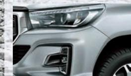
Faros delanteros de LED con proyector y regulación automática en altura. Luces diurnas (DRL) de LED.
