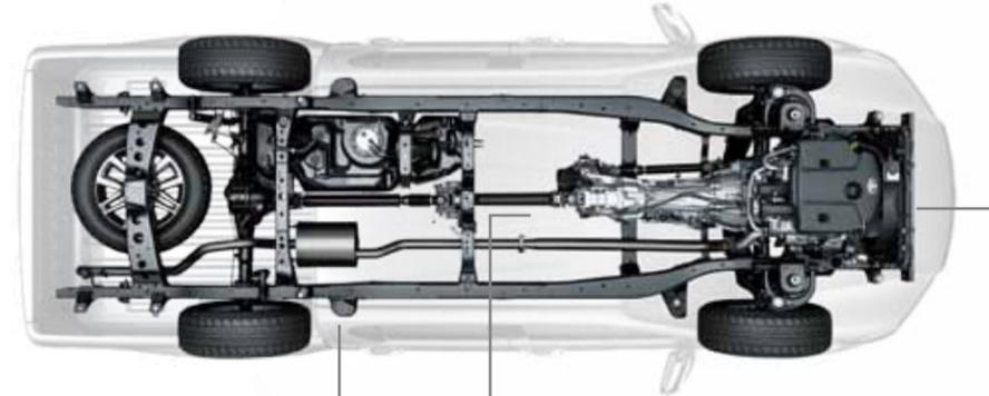
**Nuevo chasis:** Se incrementó la sección de los perfiles y se reforzó su estructura aportando mayor rigidez y durabilidad. Esto se tradujo en mayor estabilidad, confort de marcha y seguridad.
