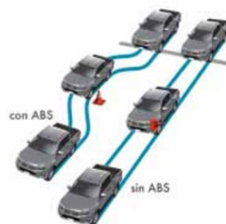
**ABS con EBD y BA:** El ABS con distribución electrónica de la fuerza de frenado (EBD), permite frenar manteniendo el control, independientemente de la cantidad de carga que lleve. El asistente de frenado de emergencia (BA) aplica presión adicional al sistema de frenos cuando detecta una frenada de emergencia.
