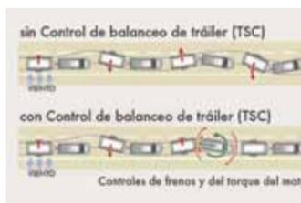
**El control de balanceo de tráiler (TSC):** Ayuda a mantener la pickup y su remolque en línea recta compensando el balanceo con los frenos y respuesta del motor.
