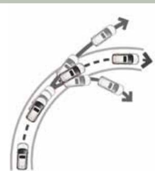
En condiciones deslizantes o cuando tomás una curva demasiado rápido, el **VSC** actúa reduciendo el deslizamiento lateral de las ruedas, ayudándote a tener la mayor adherencia y devolviéndote el control del vehículo. El control de tracción (**TRC**) gestiona los frenos y reduce el par en situaciones donde las ruedas pierden adherencia y recupera la tracción redistribuyendo la potencia entre las ruedas independientemente.<sup>2</sup>
