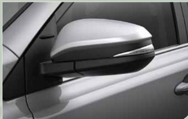
Espejos exteriores calefaccionados retráctiles con luz de giro incorporada.
