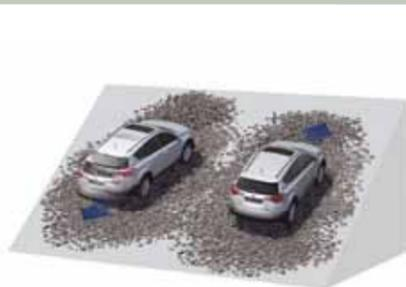
La RAV4 ofrece el control de asistencia al arranque en pendientes (**HAC**)<sup>2</sup>, que permite un arranque seguro en pendientes, manteniendo el vehículo parado hasta 2 segundos para evitar que caiga al arrancar.
