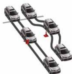
El sistema **EBD** te ayuda a mantener el control mediante un equilibrio electrónico de la fuerza de frenado entre las cuatro ruedas. Este sistema complementa al **ABS** al optimizar la fuerza de frenado que actúa sobre cada rueda. Entre ambos sistemas evitan que las ruedas se bloqueen, y te permiten rodear obstáculos mientras frena.
