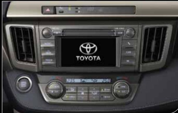
Audio con pantalla táctil LCD de 6.1", CD, MP3, Bluetooth®, entradas auxiliares, USB y 6 parlantes.<sup>1</sup>
