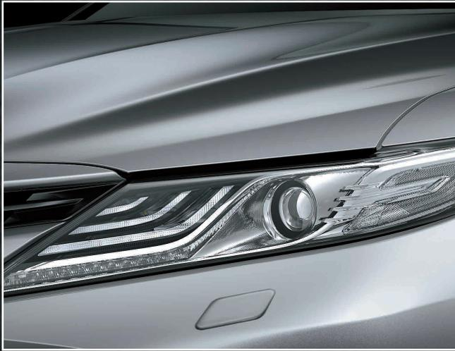
Ópticas delanteras de LED con sistema AFS.
