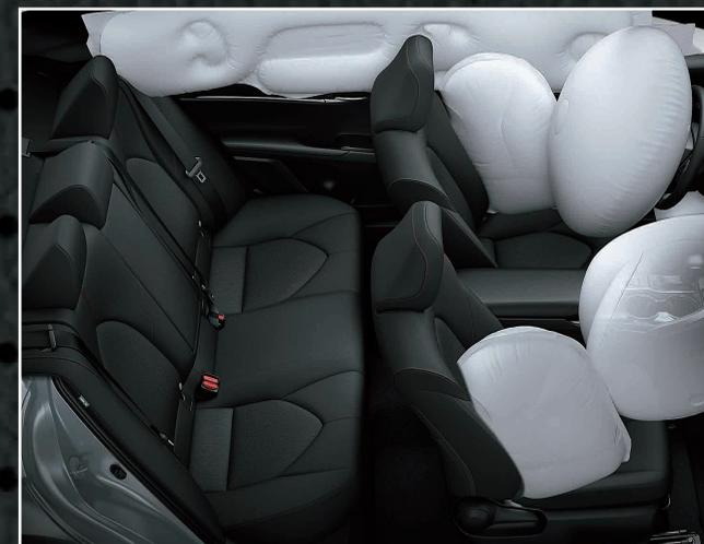
7 airbags: frontales, laterales, de cortina y de rodilla para el conductor.
